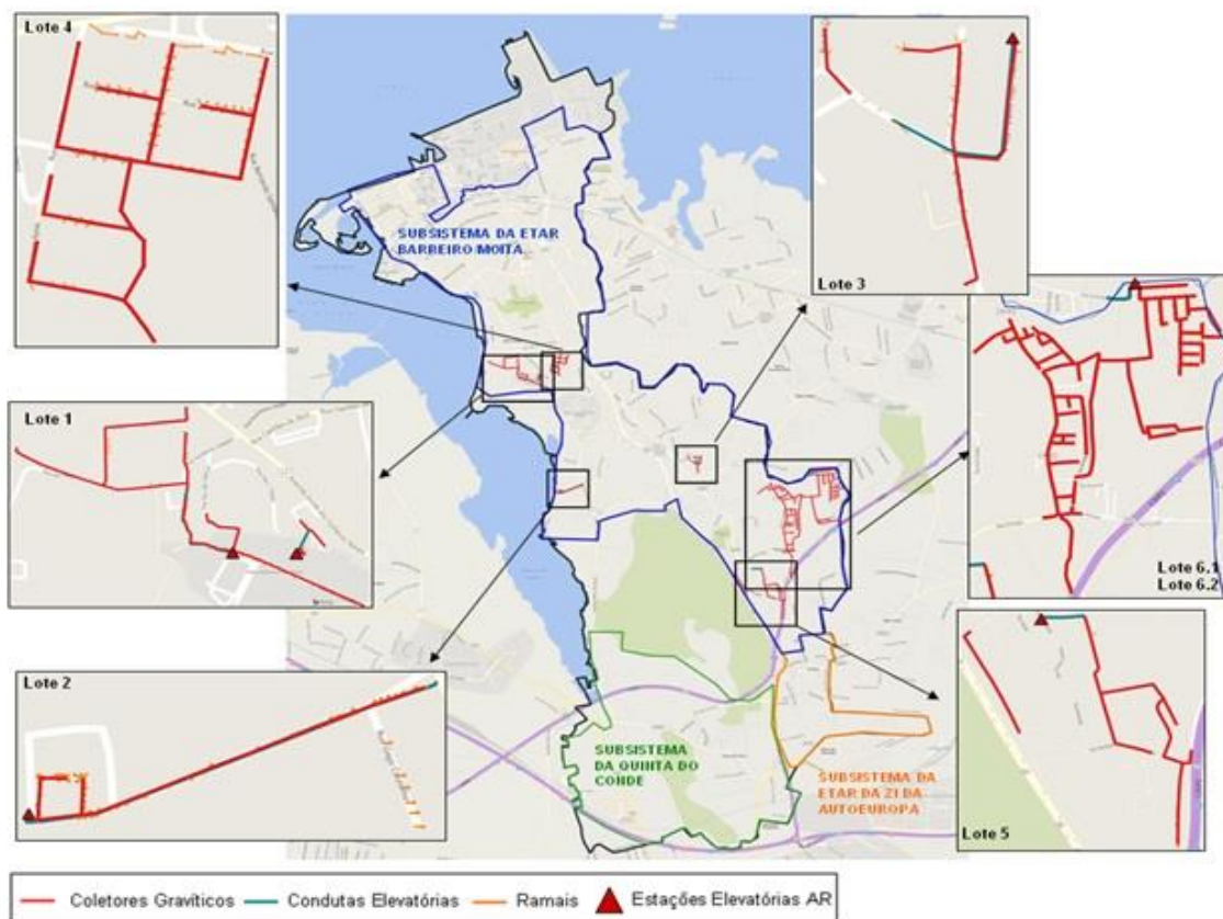
Fig 1- Intervenções no Subsistema da ETAR Barreiro/Moita
